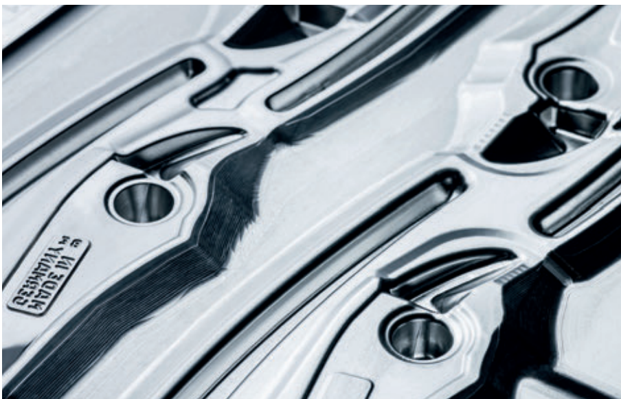
Schmiedegesenk für den Kraft-Seitenschneider mit angeschmiedeter Gelenkachse.
