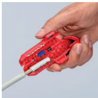
Abmanteln eines NYM-Kabels
