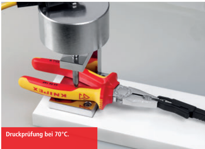
Prüfung der Haftfähigkeit der VDE-Hüllen mit 500 N.
