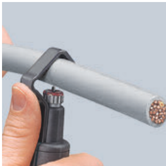
Ansetzen des Werkzeugs für Umfangsschnitt
