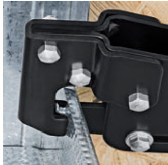
Das Stempelwerkzeug wird durch die Profilbleche gedrückt
