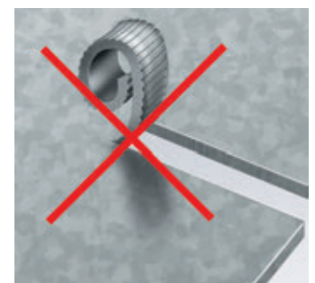
Ausklinken ohne Spanbrecher
