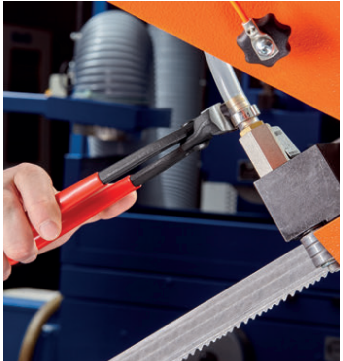
Abdichten Fluidschlauch an Stutzen mittels Seiten-Pressnase
